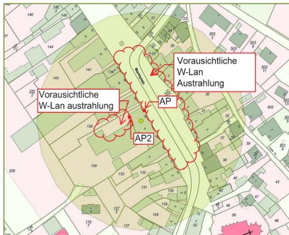
Der im Lageplan markierte Bereich kennzeichnet die zu erwartende WLAN-Ausleuchtungsfläche.
