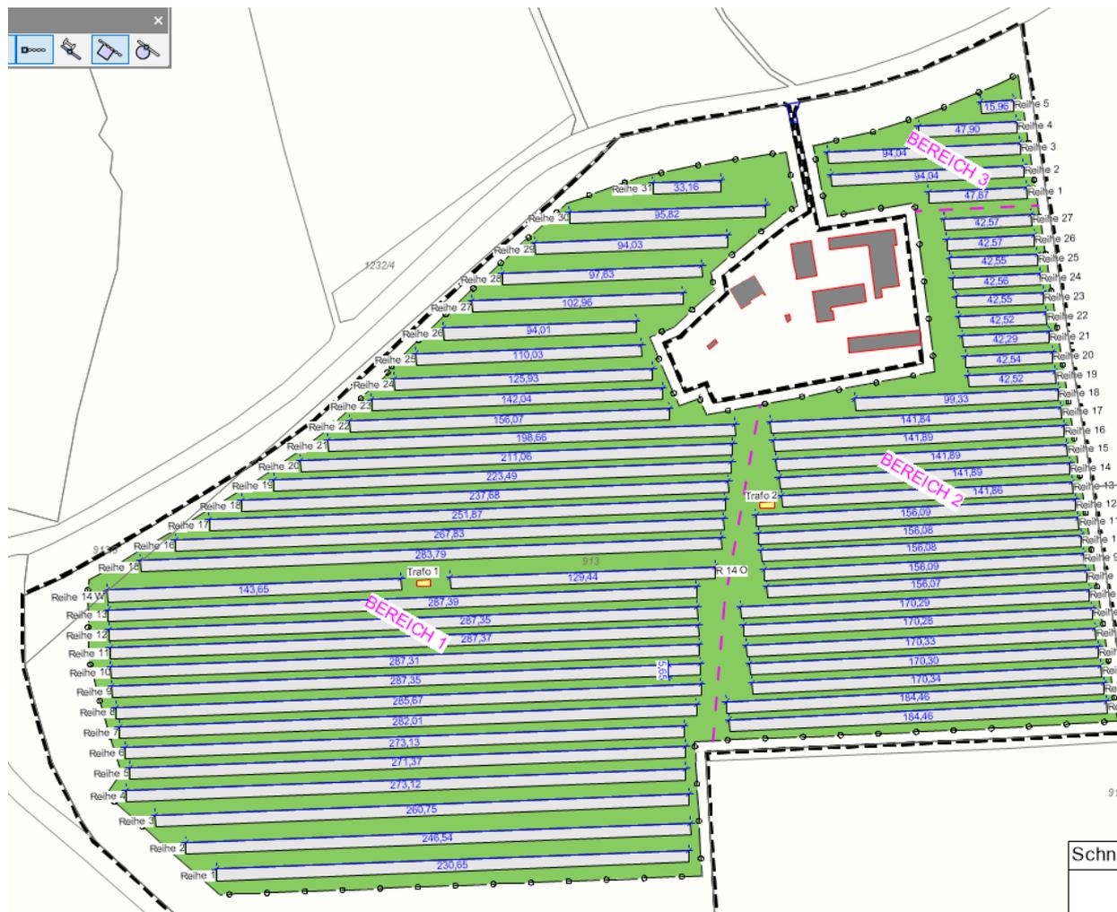
aktuell geplante Anordnung der Modulreihen und Trafostationen: vgl. Anlage 1
